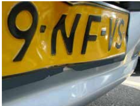
Niet acceptabel (kentekenplaat gedeukt)
