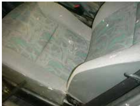
Niet acceptabel (verfvlekken)
