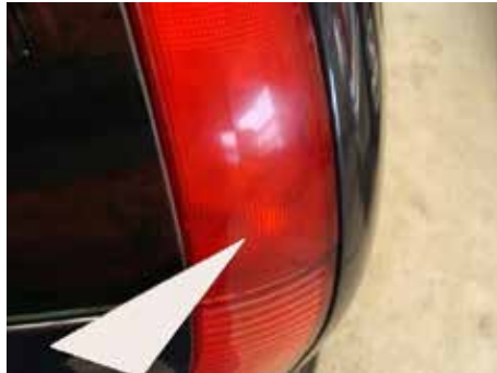
Niet acceptabel (barst in de lichtunit)
