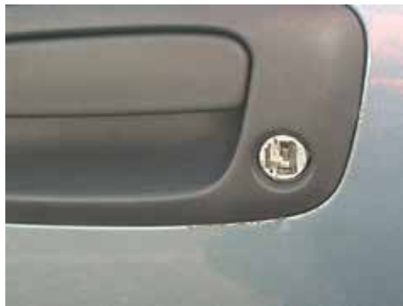
Niet acceptabel (niet gerepareerde inbraakschade)
