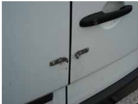
Niet acceptabel (sloten op het plaatwerk aangebracht)
