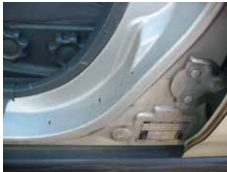
Niet acceptabel (sponning gedeukt/roestvorming)
