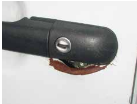
Niet acceptabel (niet gerepareerde inbraakschade)
