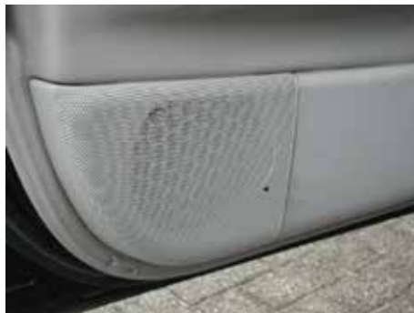
Niet acceptabel (scheuren in speakerkap)
