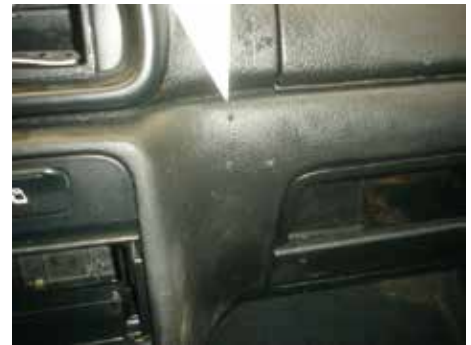
Niet acceptabel (gaten door gedemonteerde carkit)
