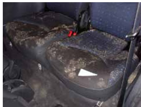
Niet acceptabel (schimmelvorming)
