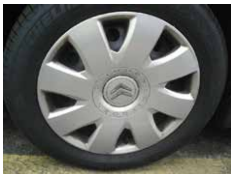
Acceptabel (lichte oppervlakkige schaafplek, max. 10 cm)
