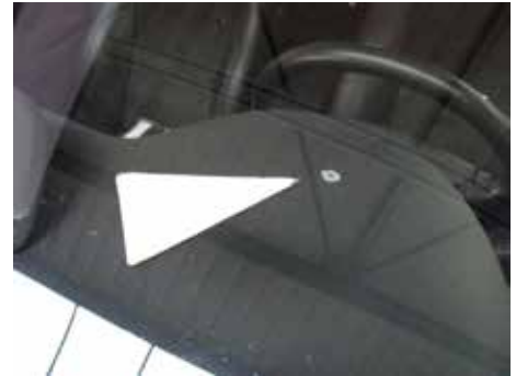
Niet acceptabel (tussenlaag warmtewerende ruit aangetast)
