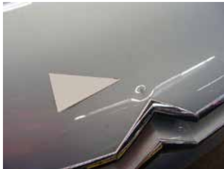
Niet acceptabel (deukje niet te modelleren)
