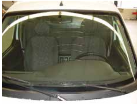
Niet acceptabel (krassen door ruitenwissers)
