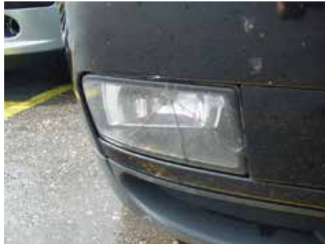
Niet acceptabel (scheur/barst in de lichtunit)
