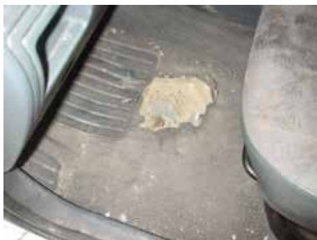
Niet acceptabel (gat in vloerbekleding)
