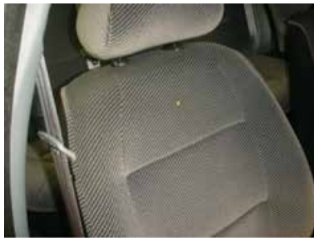
Niet acceptabel (brandgat in stoelbekleding)
