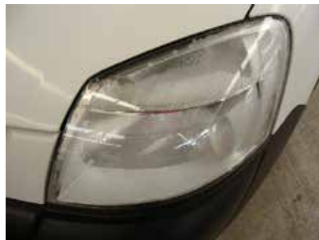
Acceptabel (condens in lichtunit; reflector niet aangetast)
