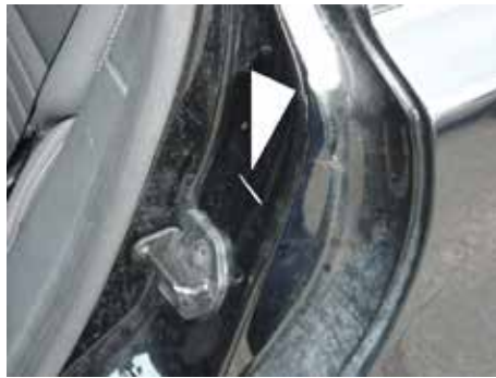
Acceptabel (krasje door de lak heen, geen roest/deukje)
